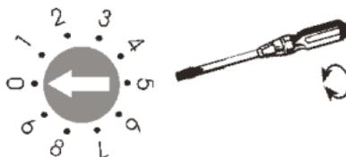
Tous les émetteurs et récepteurs d'une même installation doivent être réglés sur le même canal !
